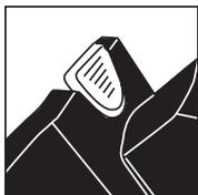
Para extraer la batería, presione la pestaña y tire de la batería.
