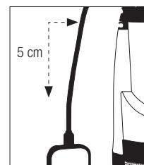
Il est important de toujours laisser au moins 5 cm de câble libre entre la bouée et le point d'attache pour que la bouée ait une capacité de mouvement suffisante.
