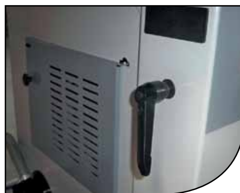
Blocage en hauteur de l'arbre de toupie Spindle shaft height adjustment locking system
